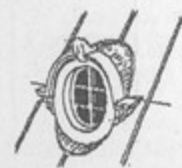
lucarne dite «œil-de-boeuf», à encadrement et habillage en zinc façonné
