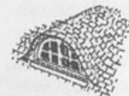
lucarne à jouées galbées (ouverture ardoise ou chêne)
